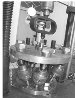
图 10 Z 轴方向力标定实验照片
