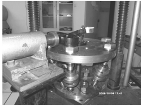
图 9 传感器 X 方向力标定实验照片
